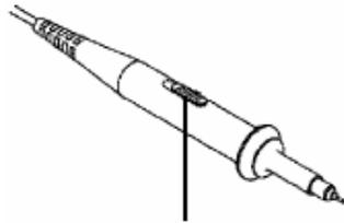
**Fig. 9** Attenuation Switch
