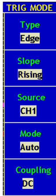
**Fig. 27** Edge Trigger Menu
